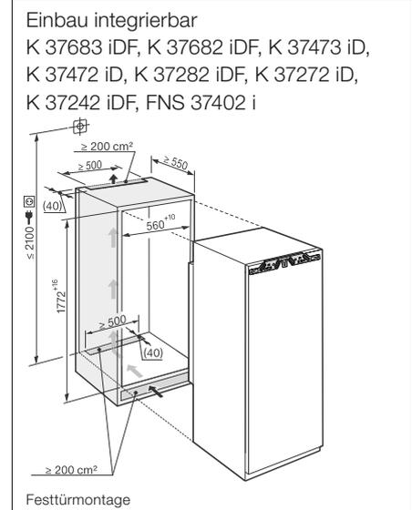
Detaillierte Einbauskizzen unter [www.miele.ch/einbauskizzen](http://www.miele.ch/einbauskizzen)
